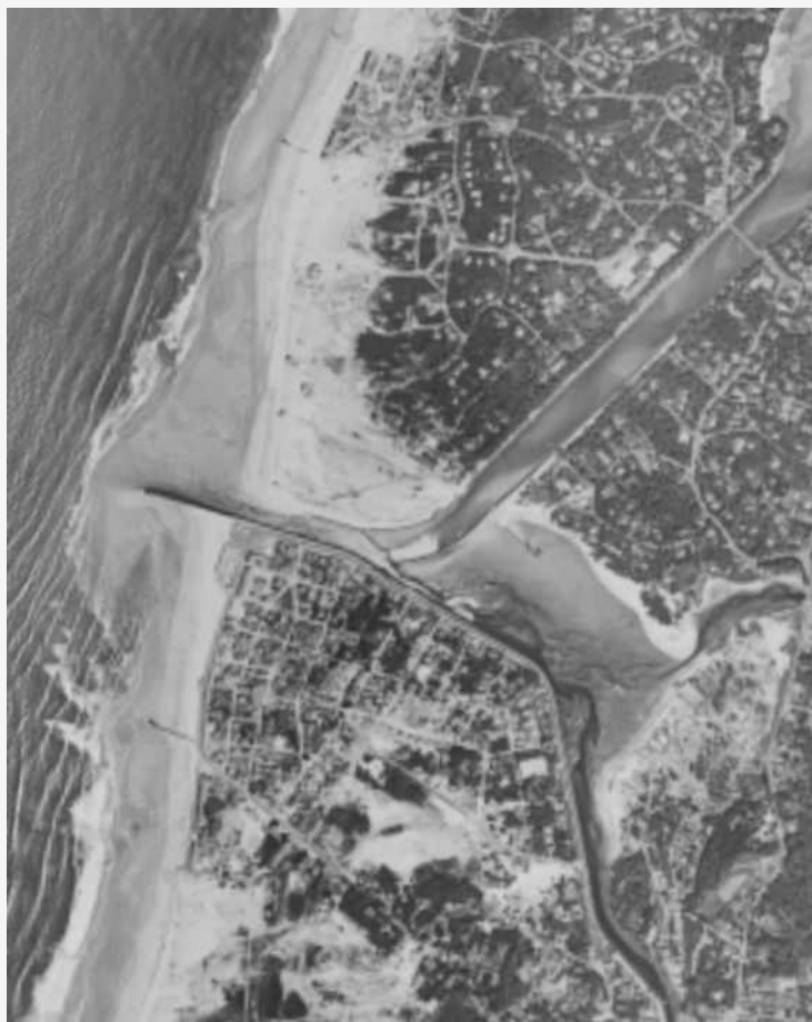
Avant l'aménagement du port actuel, le flot entrant par le Boucarot était amorti par la large ouverture de l'estuaire du Bouret et du Boudigau.
