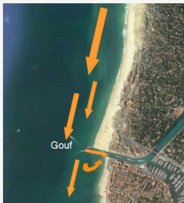
Représentation schématique du courant de dérive littorale
