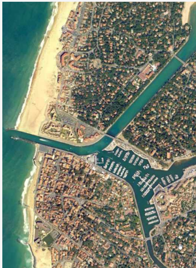
Depuis 1973, l'entrée dans le port est resserrée, le môle en triangle de la capitainerie renvoie le flot vers le nord/est : l'énergie du flux est dirigée vers le canal et le lac.
